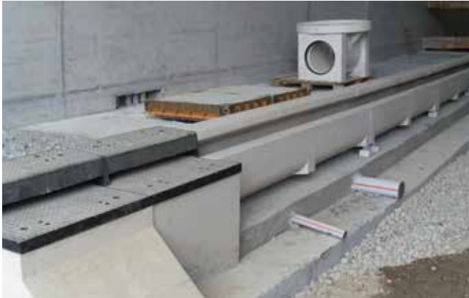
L'unità consiste in un pozzetto sifonato con parete tagliafiamma, con copertura in ghisa o calcestruzzo polimerico, chiusino di ispezione, tutto a tenuta stagna; possibile montaggio in caso di utilizzo, barriera "New Jersey".
