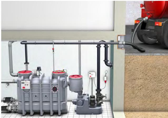
Un separatore di grassi con smaltimento totale funziona in base al principio fisico della gravità (differenza di densità), cioè le sostanze pesanti delle acque reflue cadono sul fondo del separatore e le sostanze leggere, quali grassi e oli animali, galleggiano in superficie. Le acque reflue trattate vengono scaricate nella rete fognaria tramite un tubo di uscita.
