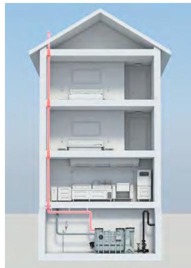
ACO LipuSmart: un condotto di ventilazione per entrambe le applicazioni integrate
