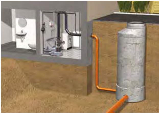
Protezione antiriflusso mediante impianto di sollevamento posto al di sopra del livello della fognatura.
