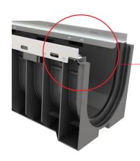
Il telaio di rinforzo in acciaio è alto 20 mm e ha uno spessore di 2,5 mmnella parte esposta al transito dei veicoli. Contiene la griglia e facilita la posa in opera del canale.
