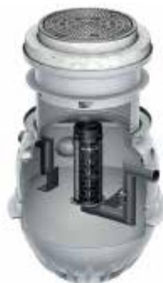
I separatori **Coalisator-P** sono stati progettati per la ritenzione di liquidi leggeri di origine minerale inclusi nelle acque reflue. Il prodotto è progettato per installazione a pavimento in locali protetti dal gelo o installazione interrata all'interno e all'esterno di edifici.
