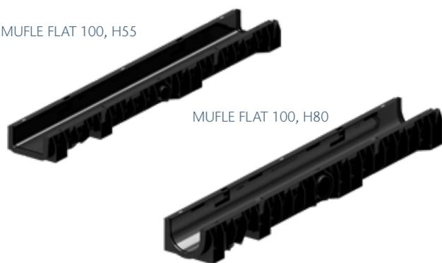
FLAT è un sistema pratico, versatile ed economico, composto da una canaletta interamente realizzata in PE-HD che non prevede alcun telaio di rinforzo, idoneo dalla classe A15 fino alla C250. La gamma è composta da 2 canali con 1 larghezza e 2 altezze.
