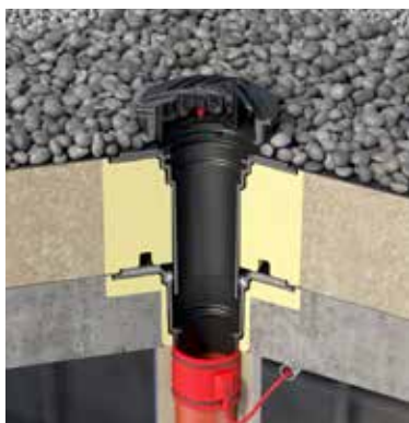
Corpo di scarico bielemento in ghisa o acciaio inox con flangia di tenuta per guarnizione pressata
