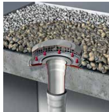
Corpo di scarico monoelemento in ghisa o acciaio inox con flangia di tenuta per guarnizione pressata
