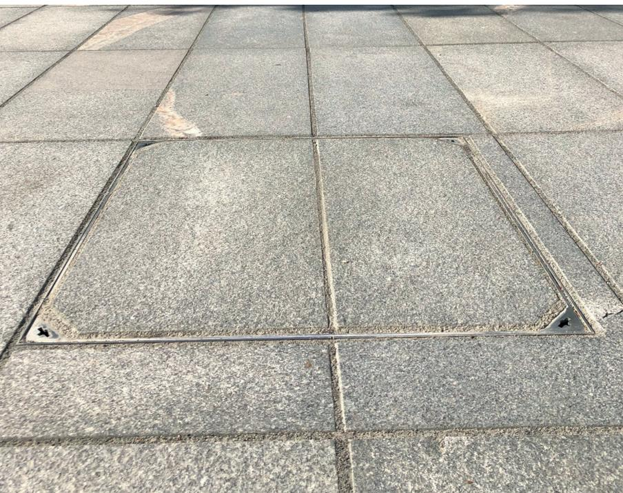
Ideali per esterni, come zone pedonali, passi carrai e parcheggi, i chiusini Paving sono realizzati in acciaio zincato a caldo e dotati di guarnizioni per la tenuta all'acqua e agli odori. Sono adatti per pavimentazioni in masselli autobloccanti e pietra naturale con altezze fino a 110 mm. I robusti supporti saldati sotto il chiusino garantiscono capacità di carico fino alla classe C250 senza necessità di riempimento strutturale.
